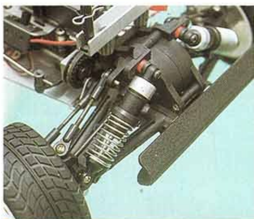
↑ダンパーはブレッシャータイプだが、ケースが樹脂製のため軽量化に仕上がっている。
