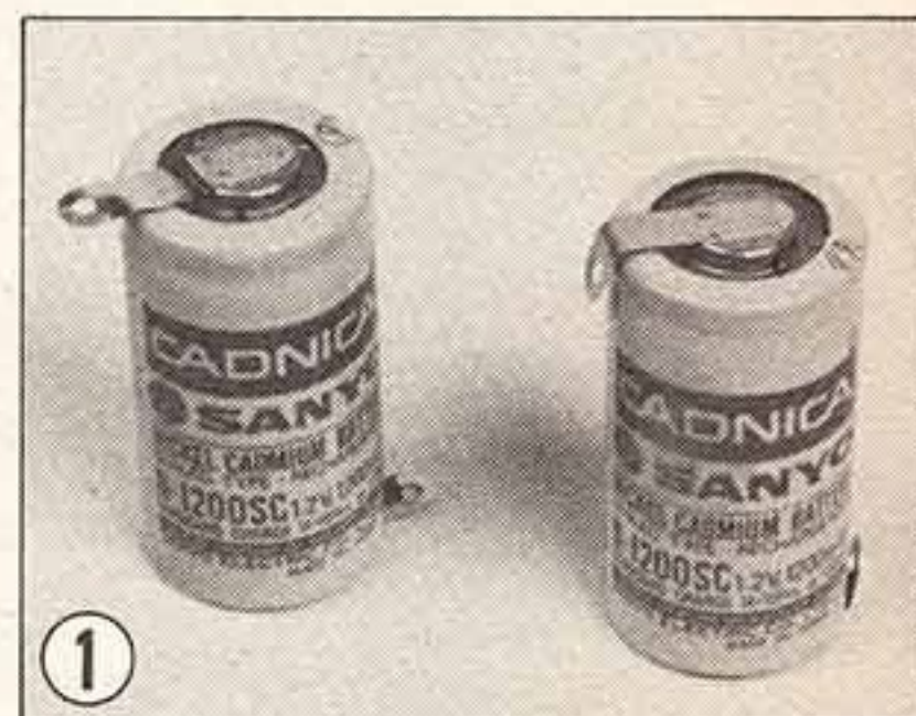
① ↑まず端子を左のセルのように水平にのばしておこう
