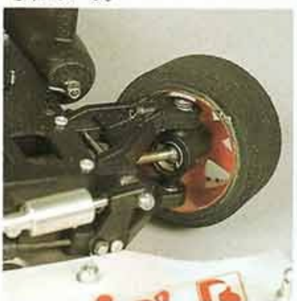
↓スプリント同様、スイングシャフトは、両端ピン・タイプが採用されている。
