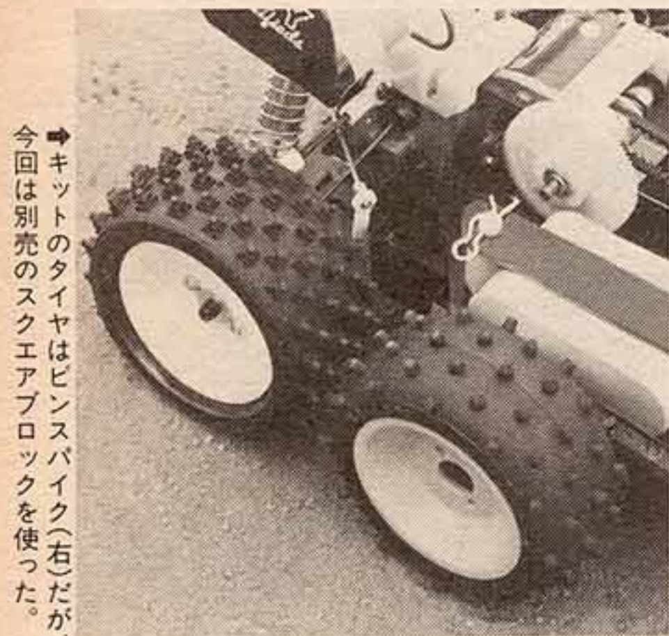
⇒ドッグファイトと同タイプの3分割式タイロッド。メカ搭載にはコツがいる。
