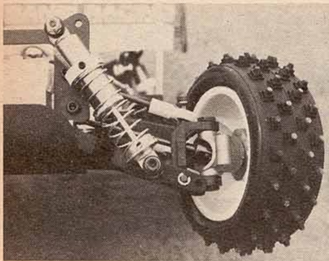
←ユニバーサルジョイントも標準装備している。フロントはトレッド変更も可能。
